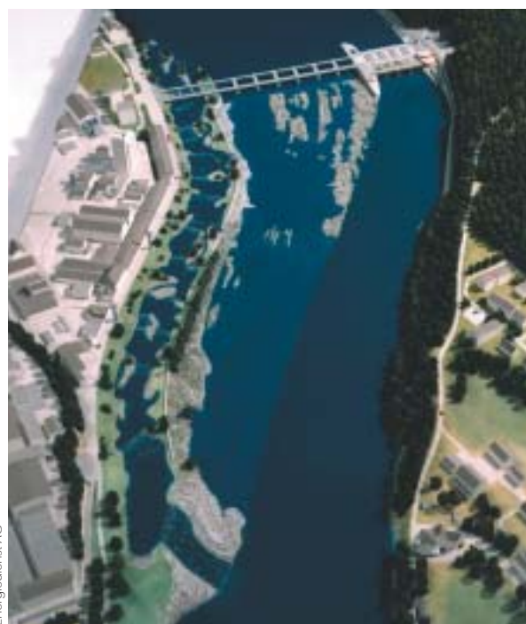
Model van de vispassage bij de waterkrachtcentrale Rheinfelden.
