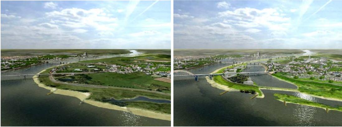
Abbildung 5b: Beispiel für die flusserweiternde Maßnahme bei Lent/Nijmegen, Niederlanden. Deichrückverlegung Lent, links: heutige Situation, rechts: zukünftige Situation (Programm „Raum für den Fluss“, Projekt „Raum für den Waal“ <http://www.ruimtevoordewaal.nl> /©: Ruimte voor de Waal.)
