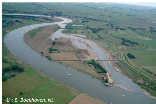
Photo : réalisation sur l'IJssel d'un système de bras latéraux conforme à l'état de référence (Vreugderijkerwaard)
