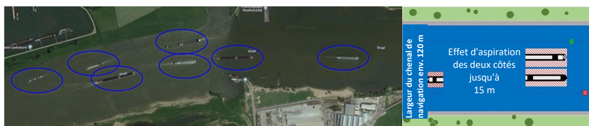
Fig. 50 : Liens : Le trafic fluvial sur le Waal (NL) est le plus intense de tous les tronçons du Rhin (source : Google Maps, 2023) ; à droite : représentation schématique de la zone latérale de danger avec une largeur de chenal d'environ 120 m et un trafic de gros porte-conteneurs
