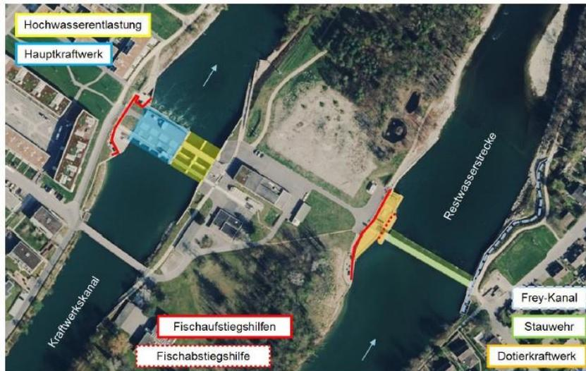
**Figure 1 :** Vue d'ensemble des installations de la centrale de Rüchling (ArcGIS, consulté le 18.09.2018).
