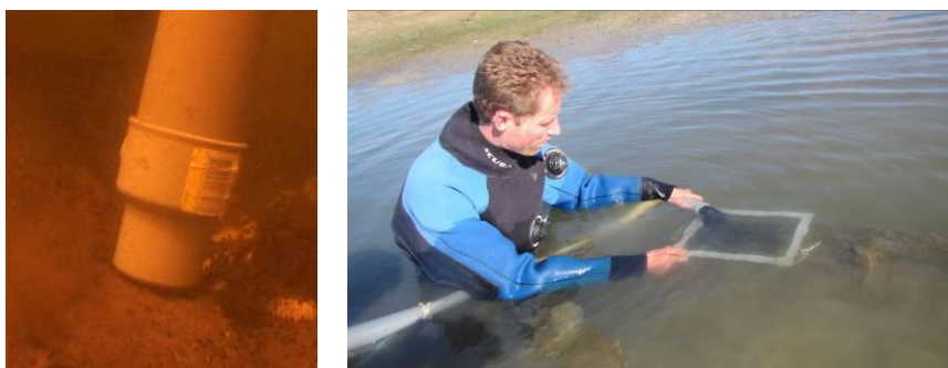
Figure 3: aspirateur de macrozoobenthos en action (à gauche) ; plongeur avec quadrat dans lequel le macrozoobenthos est aspiré par brossage (suction, à droite) ; photo : Wendy Liefveld, Bureau Waardenburg.
