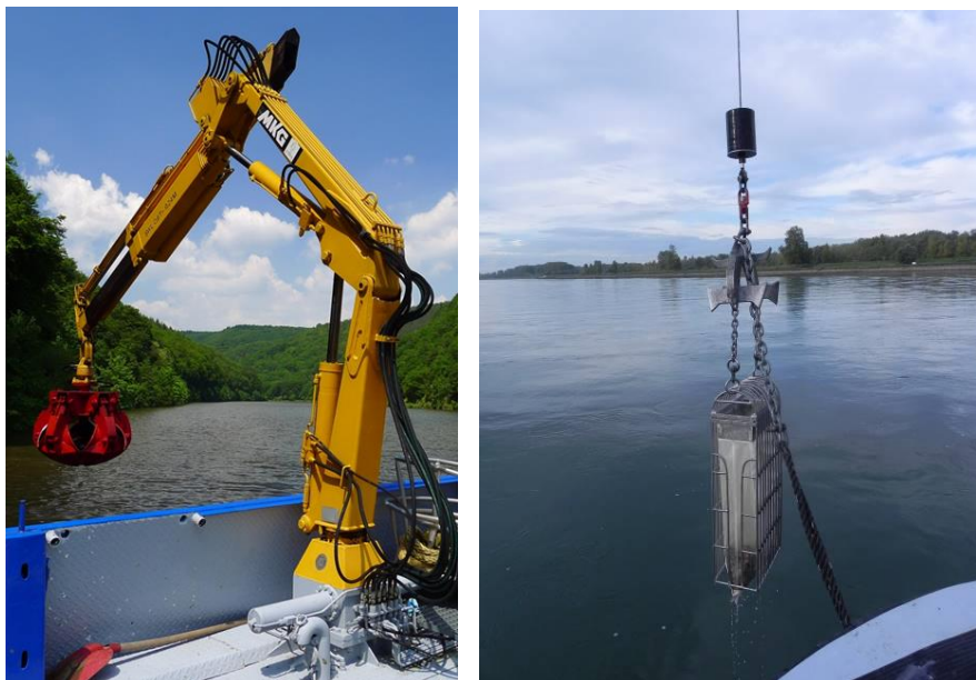
Figure 2 : prélèvements effectués avec le bateau-laboratoire d'analyse MS Burgund. Le grappin remonte à la surface des échantillons retirés du fond de grands cours d'eau navigables (photo de gauche : LfU, J. Fischer) ; grappin (photo de droite, LUBW).
