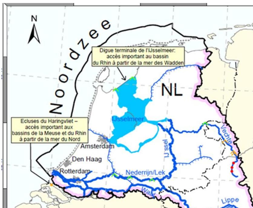
**Figure 1 : ouvrages transversaux dans le delta du Rhin.** Point : sans dispositif de montaison ; crochets : avec dispositif de montaison. Vert : franchissable ; orange : franchissabilité restreinte ; rouge : non franchissable. Extrait de la carte K 7 du projet de 2<sup>e</sup> PdG Rhin, version de décembre 2015.
