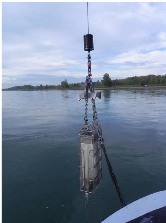
Figure 2 : prélèvements effectués avec le bateau-laboratoire d'analyse MS Burgund. Le grappin remonte à la surface des échantillons retirés du fond de grands cours d'eau navigables (photo de gauche : LfU, J. Fischer) ; grappin (photo de droite, LUBW).
