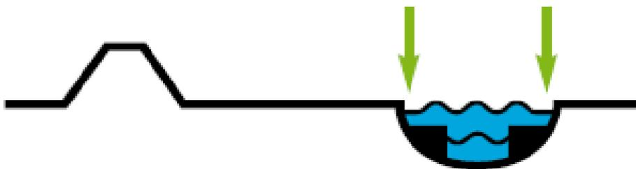
Abaissement d'épis sur les voies navigables. Il en résulte une meilleure évacuation de l'eau et, par là même, une baisse du niveau d'eau en situation de crue.
