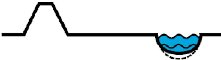
Le lit mineur est approfondi par creusement. Cette mesure a pour effet d'augmenter la capacité à un niveau d'eau constant.
