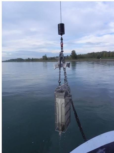
Abbildung 2: Probenahme mit dem Mess- und Laborschiff MS Burgund. Der Greifer birgt Proben vom Grund großer, schiffbarer Gewässer (Foto links: LfU, J. Fischer); Dredge (Foto rechts, LUBW).
