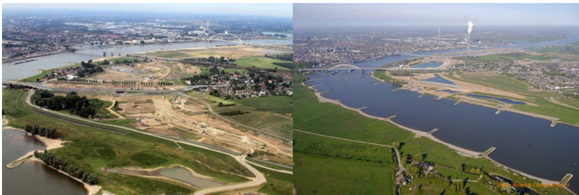
Figuur 32: Dijkteruglegging en nevengeul Lent/Nijmegen (Waalkm 883). Situatie voor (links) en na (rechts) de maatregel (foto's: Rijkswaterstaat)
