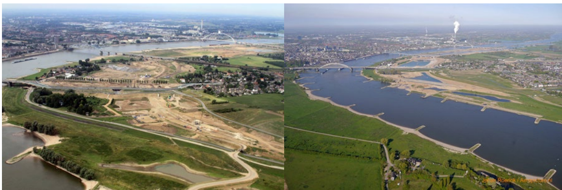
Figuur 31: Dijkteruglegging en nevengeul Lent/Nijmegen (Waalkm 883). Situatie voor (links) en na (rechts) de maatregel (foto's: Rijkswaterstaat)
