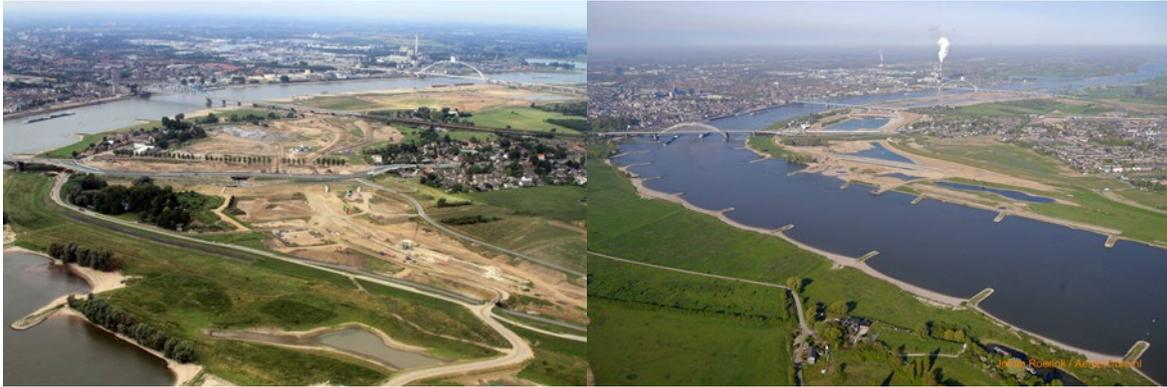
**Figure 32** : Recul d'une digue et chenal latéral Lent / Nimègue (PK 883 du Waal), avant (à gauche) et après (à droite) la mesure (photos : Rijkswaterstaat)
