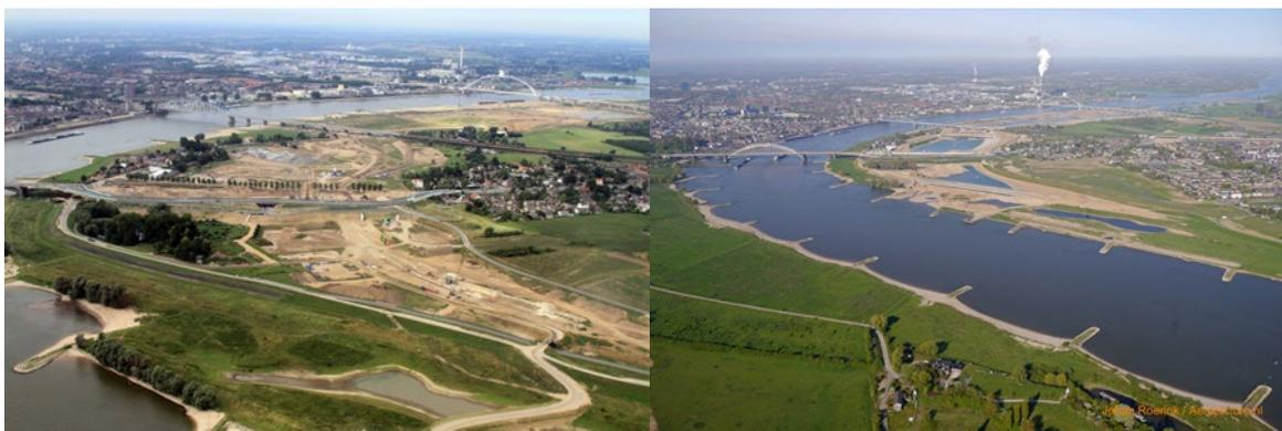
**Figure 31** : recul d'une digue et chenal latéral Lent / Nimègue (PK 883 du Waal), avant (à gauche) et après (à droite) la mesure (photos : Rijkswaterstaat)
