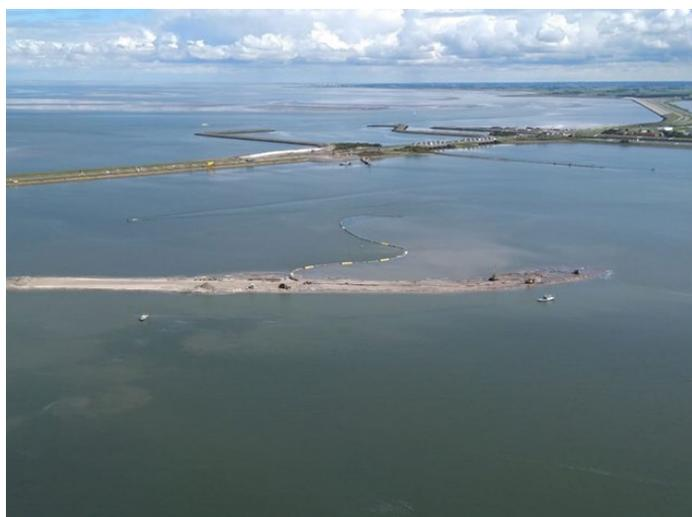
**Figure 24** : construction de la rivière de migration des poissons, juillet 2020 © Rijkswaterstaat
