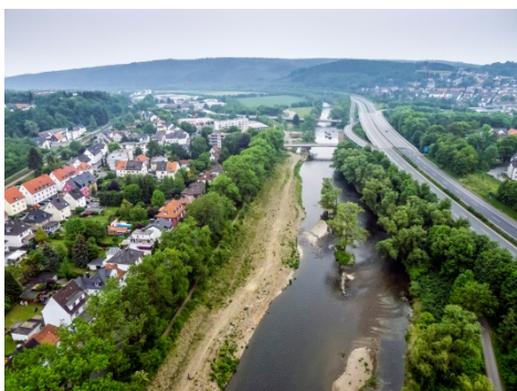
Figure 42 : la Ruhr à hauteur d'Arnsberg ; au premier plan un tronçon renaturé, à l'arrière-plan un tronçon non restauré. Photo : G. Bockwinkel, MKULNV NRW
