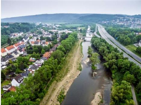
**Abbildung 42:** Ruhr bei Arnsberg; im Vordergrund ein renaturierter Abschnitt, im Hintergrund ein nicht renaturierter Abschnitt. Foto: G. Bockwinkel, MKULNV NRW
