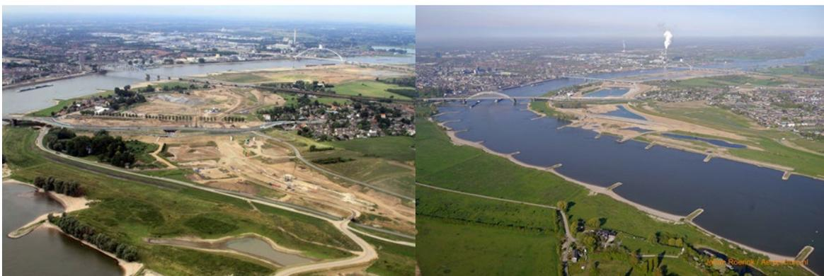
**Abbildung 31:** Deichrückverlegung und Nebengerinne Lent / Nijmegen (Waal km 883) Situation vor (links) und nach (rechts) der Maßnahme (Fotos: Rijkswaterstaat)
