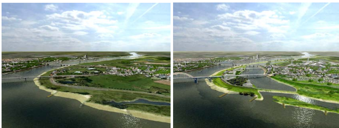
Figuur 5b: Voorbeeld van rivierverruimende maatregelen bij Lent/Nijmegen (Nederland). Dijkverlegging Lent, links: huidige situatie, recht: toekomstige situatie (programma "Ruimte voor de rivier", project "Ruimte voor de Waal" http://www.ruimtevoordewaal.nl / ©: Ruimte voor de Waal)
