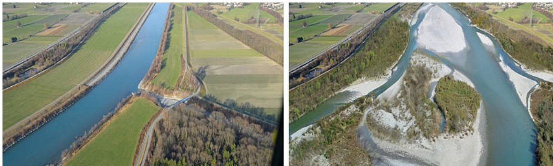
Figuur 5a: Voorbeeld van een maatregel om de Alpenrijn aan de monding van de Frutz in Au, Vorarlberg (Oostenrijk) meer ruimte te geven (bron: Renaturierung Alpenrhein / ©: Internationale Rheinregulierung IRR/Hydra-Institute, Peter Rey)
