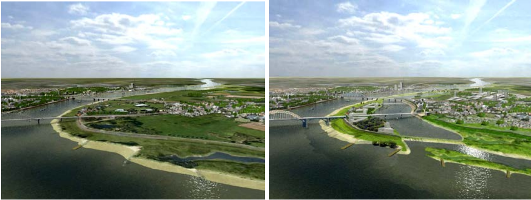
Figure 5b : exemple de mesure d'élargissement de l'espace fluvial à Lent/Nimègue. Recul de digues à Lent, à gauche : situation actuelle, à droite : situation future (programme « Espace pour le fleuve », projet « Espace pour le Waal » http://www.ruimtevoordewaal.nl /©: Ruimte voor de Waal.)
